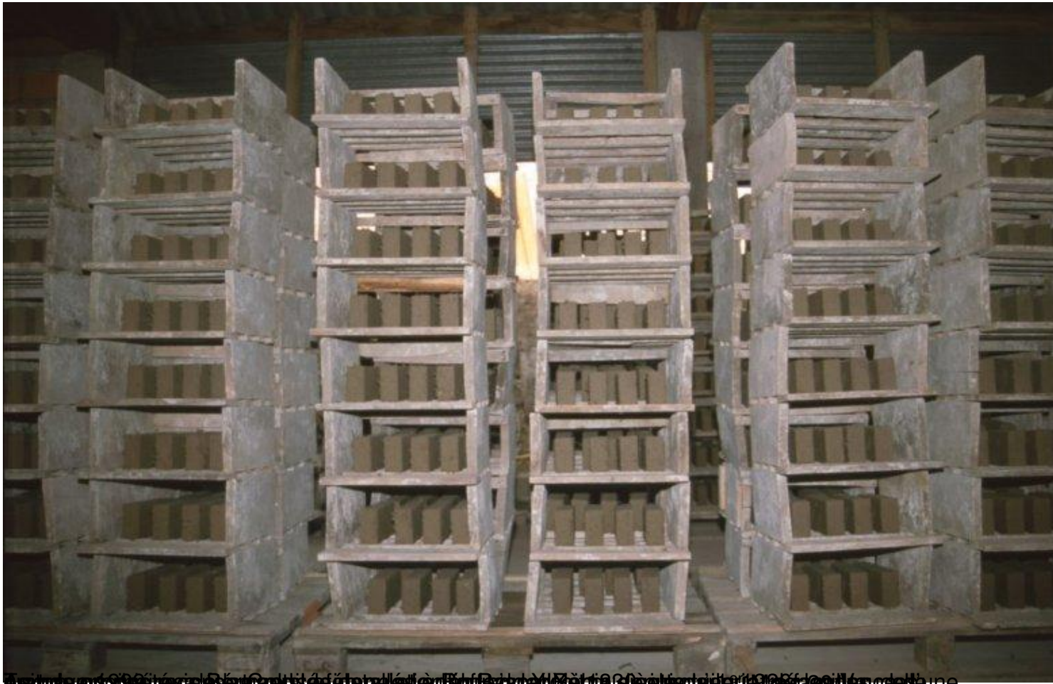
Les racks en bois utilisés pour sécher les briques avant leur cuisson dans le four à briques.
